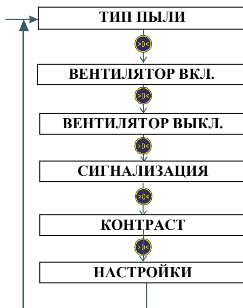
Рис. 5.5. Структура меню прибора АЭРОКОН-П
